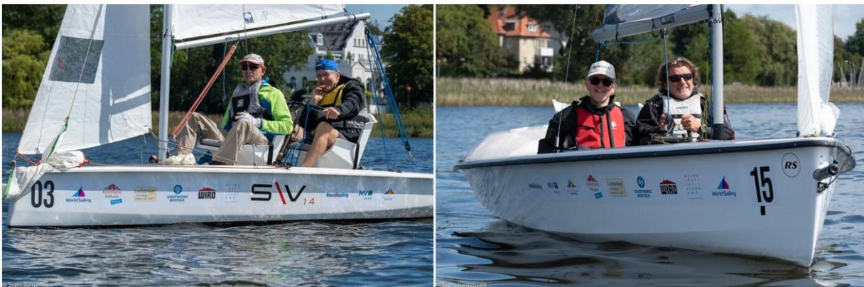
Im RS Venture Connect Boot sitzen die Segler nebeneinander in 2 Schalensitzen. Das Boot wird mit einer Art Joy Stick (Steuerknüppel) gesteuert. In der Mitte des Bootes befindet sich eine zentrale Bediensäule. Von dieser werden das Großsegel, Vorsegel und die Trimmrichtungen des Großsegels bedient. Das Genaker-fall und der -niederholer und die dazugehörigen Schoten sind so geführt, dass der Vorschoter sie aus dem Schalensitz bedienen kann.
